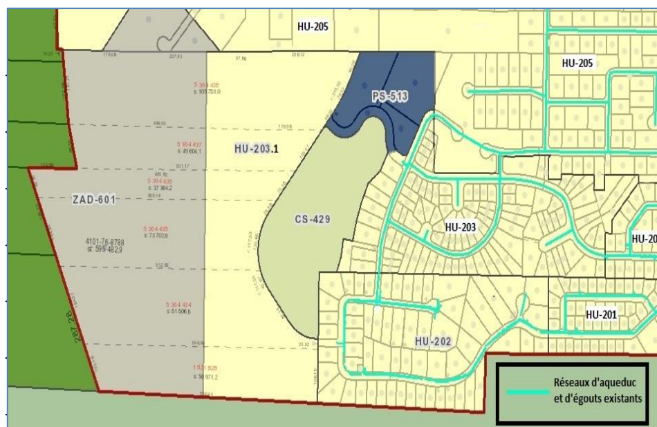
Figure 5 : Réseaux d'égout et d'aqueduc existants
