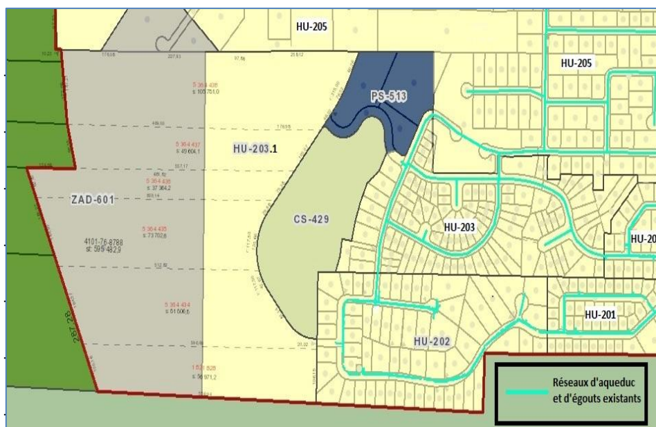
Figure 5 : Réseaux d'égout et d'aqueduc existants
