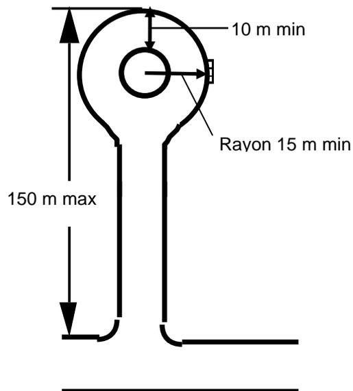
**Figure 6 - Longueur maximale d'un cul-de-sac**
