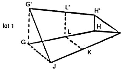
La pente moyenne du lot 1, soit G, H, I, J, se calcule en faisant la moyenne des pentes JG', KL' et IH'.
