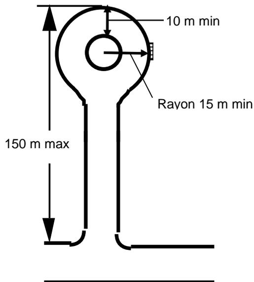
**Figure 6 - Longueur maximale d'un cul-de-sac**
