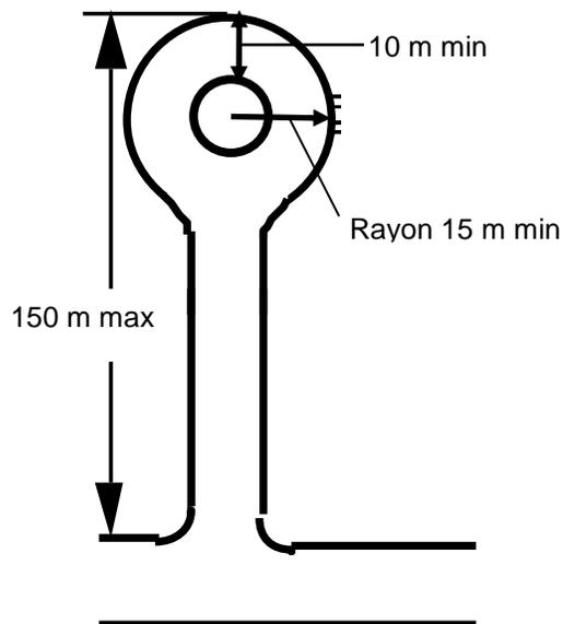
**Figure 6 - Longueur maximale d'un cul-de-sac**
